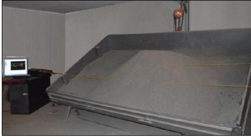
ekil 7. Laboratuvar çalışmaları için kullanılan heyelan simülasyonu
