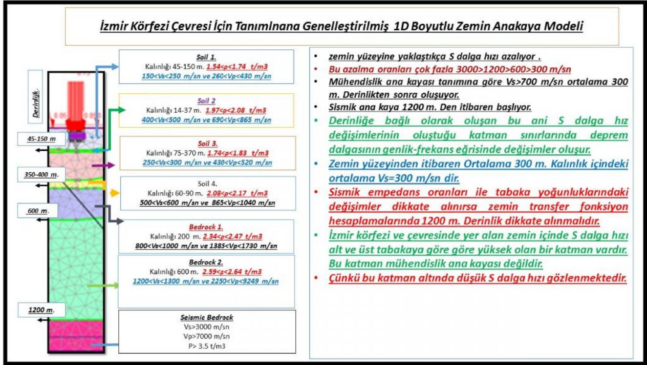
ekil 7. zmir Körfezi çevresi için genelleştirilmiş 1D zemin-ankaya modeli
