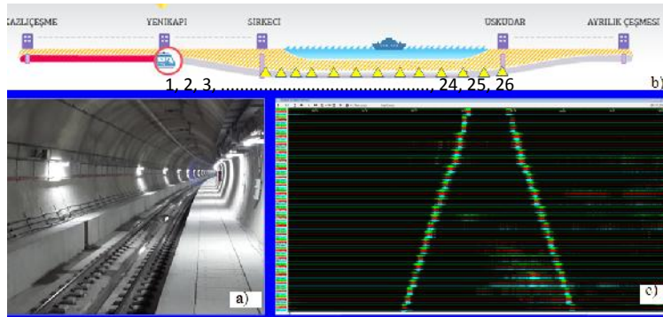
Şekil 6. a) Marmaray Tüneli geçit sisteminin görüntüsü, b) tünel içinde kurulan ve 26 adet kuvvetli yer hareketi kayıtçısından oluşan lokal sismik ağın sarı üçgenler ile gösterimi, c) Avrupa-Asya ve Asya-Avrupa yönünde ilerleyen farklı iki trenin tüpten geçi esnasında kaydedilen dalga şekilleri
