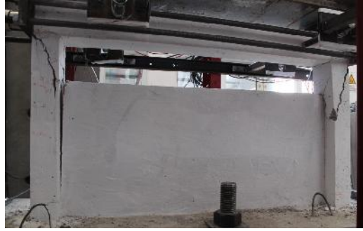
ekil 3. Onarım öncesi kısa kolon hasarı görmüş numune (CFRPE_02)
