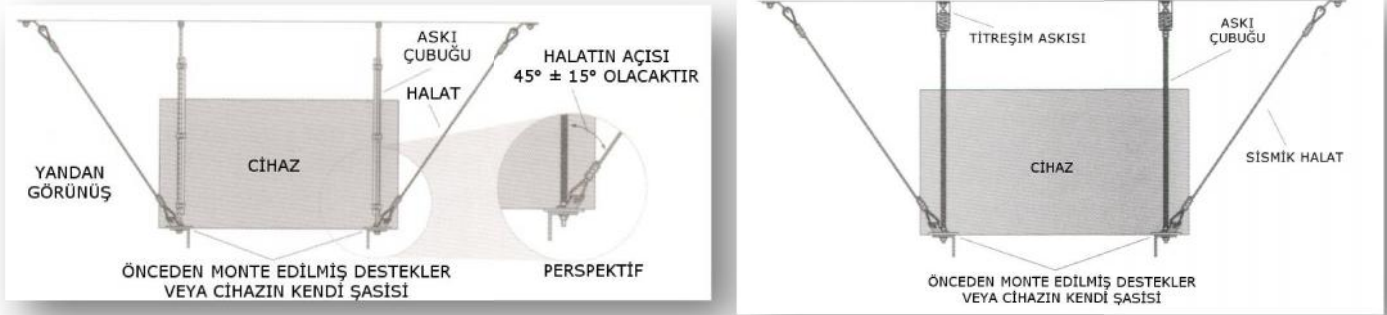
Şekil 5. Tavana asılı ekipmanlar (Titresim Yalıtımsız ve Titresim Yalıtımlı)
