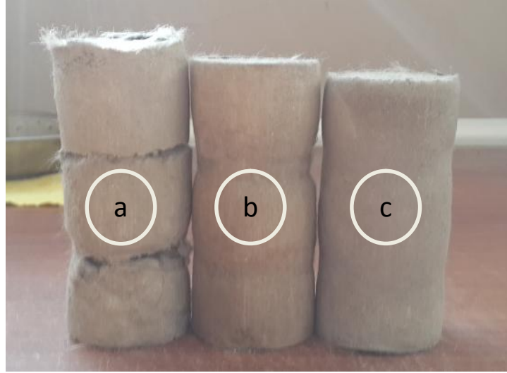
ekil 6. Çevrimsel Yükleme Sonrasındaki Eksenel Boy Değişimi ile İlgili Görsel a) Fiber Oranı %2, b) Fiber Oranı %1, c) Fiber Oranı %0.5
