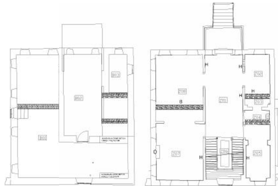
ekil 6. iyileştirme yapılan doğu-batı yönündeki yeni taşıyıcı duvarlar: solda bodrum, sağda zemin kat
