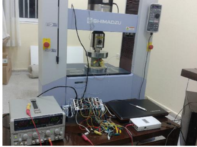
Şekil 2. Basınç testi a) Örnek teste hazır b) Örnek testte c) Devre teması d) Ekipman (soldan sağa, doğru akım kaynağı, veri toplama cihazı, PC, DMM).
